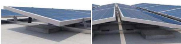
Figure 41 : Exemple d'une structure double orientation Est-Ouest inclinée à 10° avec des lests béton (source : TENERGIE)
