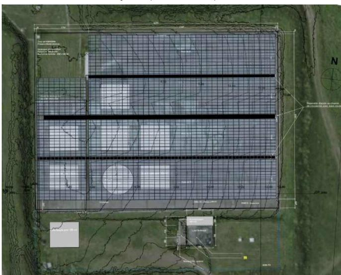
Ces câbles seront acheminés par l'intermédiaire d'une tranchée. Ce système permet de garantir la sécurité et d'assurer un meilleur esthétisme (absence de poteaux électriques et de lignes aériennes). Il nécessite le creusement de tranchées de 70 à 90 cm de profondeur.
